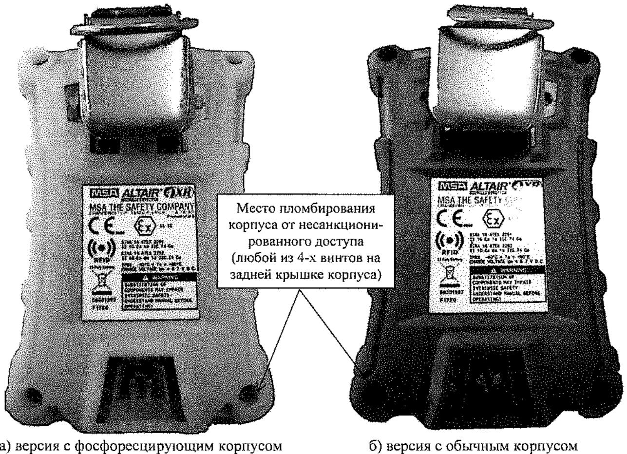
Рисунок 2 - Схема пломбировки корпуса газоанализаторов от несанкционированного доступа
