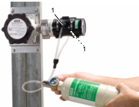
Рис. 15 Калибровка с помощью HART
