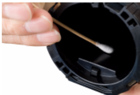
Рис. 21 Чистка диода калибровочного колпачка.
