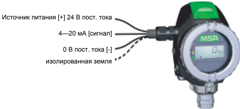
Рис. 5 3-проводное соединение — PrimaX P
