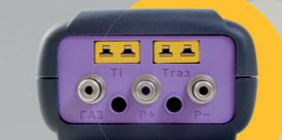
Два разъема для подключения термопар типа K
