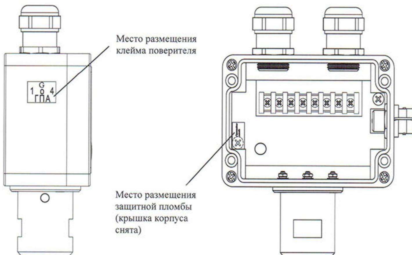
Рисунок 2 – Схема пломбировки сигнализаторов от несанкционированного доступа и размещения отиска клейма поверителя
