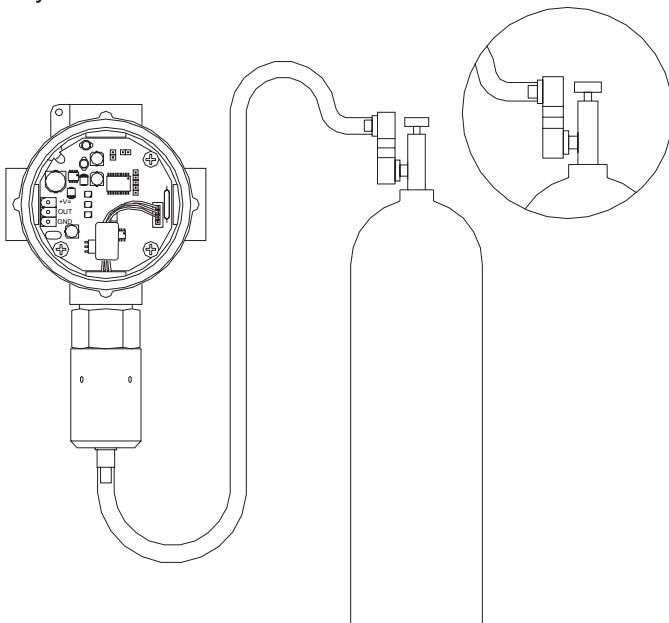
Поток газа, подаваемого на передатчик, должен быть  $0,2\ldots0,5 \text{ л/мин}$  и оставаться постоянным в течение всего испытания. В первоначальный момент, когда газ прибывает, выходное значение постепенно увеличивается до момента стабилизации (приблизительно 1 минута). После того, как значение станет постоянным нужно произвести считываение его на центральном блоке и сравнить со значением ПГС баллона.
